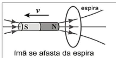
“Neste contexto, pode-se inferir que o afastamento do ímã produz um(a) \_\_\_\_\_ do fluxo magnético através da espira e, conseqüentemente, uma corrente induzida, no sentido \_\_\_\_\_.” Assinale a alternativa que completa correta e sequencialmente as lacunas anteriores.
