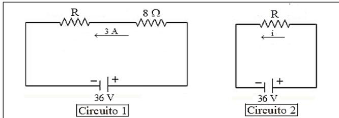
No circuito 1, uma resistência elétrica  $R$ , de valor desconhecido, está ligada em série com uma resistência de  $8 \Omega$ . Uma bateria de  $36 \text{ V}$  gera, nesse circuito, uma corrente de  $3 \text{ A}$ . No circuito 2, a mesma resistência  $R$ , ligada à bateria de  $36 \text{ V}$ , gera uma corrente elétrica de intensidade  $i$ . Neste contexto, considerando a lei de Ohm, os valores de  $R$  e  $i$  serão, respectivamente:
